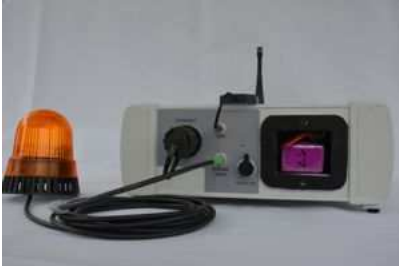
Abbildung 3: Ground-FLARM mit Sirene und Warnblitzlicht von hinten
