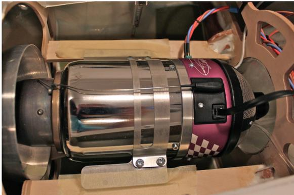
Dazu gibt es verschiedene sicherheitsrelevante Massnahmen, die unbedingt zu beachten sind. Das fängt bereits bei der Installation der verschiedenen Komponenten an. Beim Betrieb eines Strahltriebwerkes entstehen sehr hohe Drehzahlen, hohe Temperaturen, Vibrationen und nicht zu unterschätzende Kräfte. Bei entsprechenden Wetter- und Pistenverhältnissen können in diesen meistens aus Kunststoff gefertigten Modellen auch enorme elektrostatische Ladungen entstehen.
