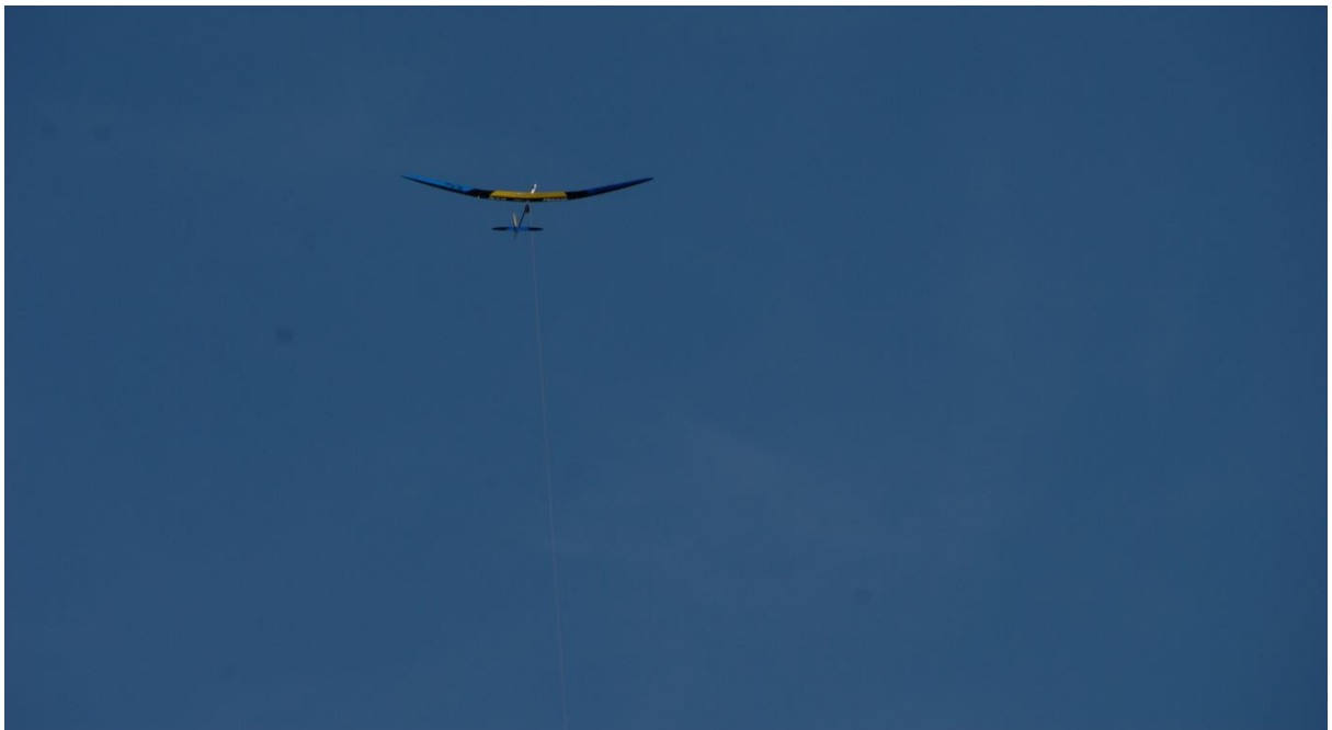
Immer noch am Seil, man beachte die nach Oben gebogenen Flügel! Da ist eine enorme Belastung darauf.
