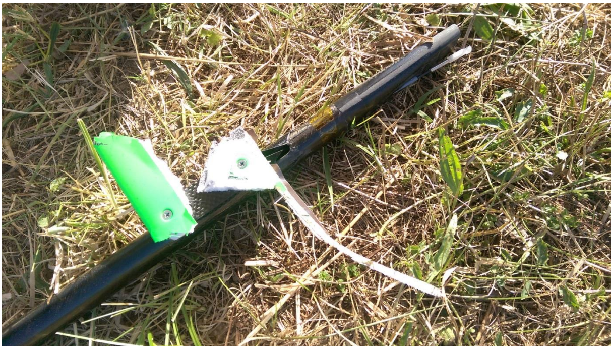
Ach ja, hier sind auch noch ein paar Teile des Höhenruders, aber auch der Pylon sieht nicht mehr so frisch aus.
