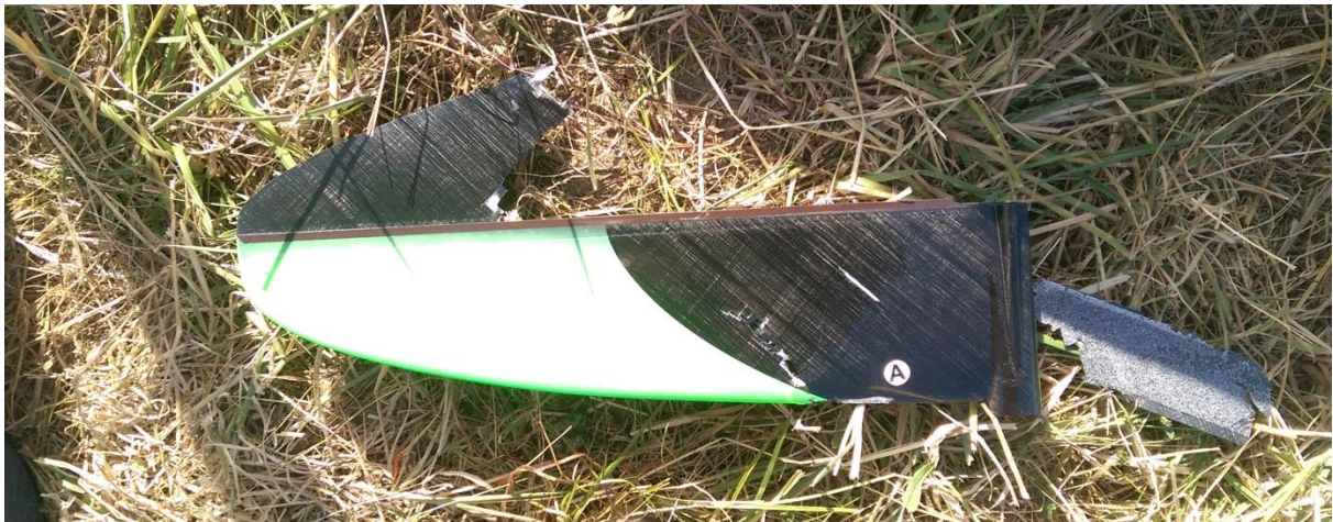
Und so sieht das modifizierte Seitenruder aus
